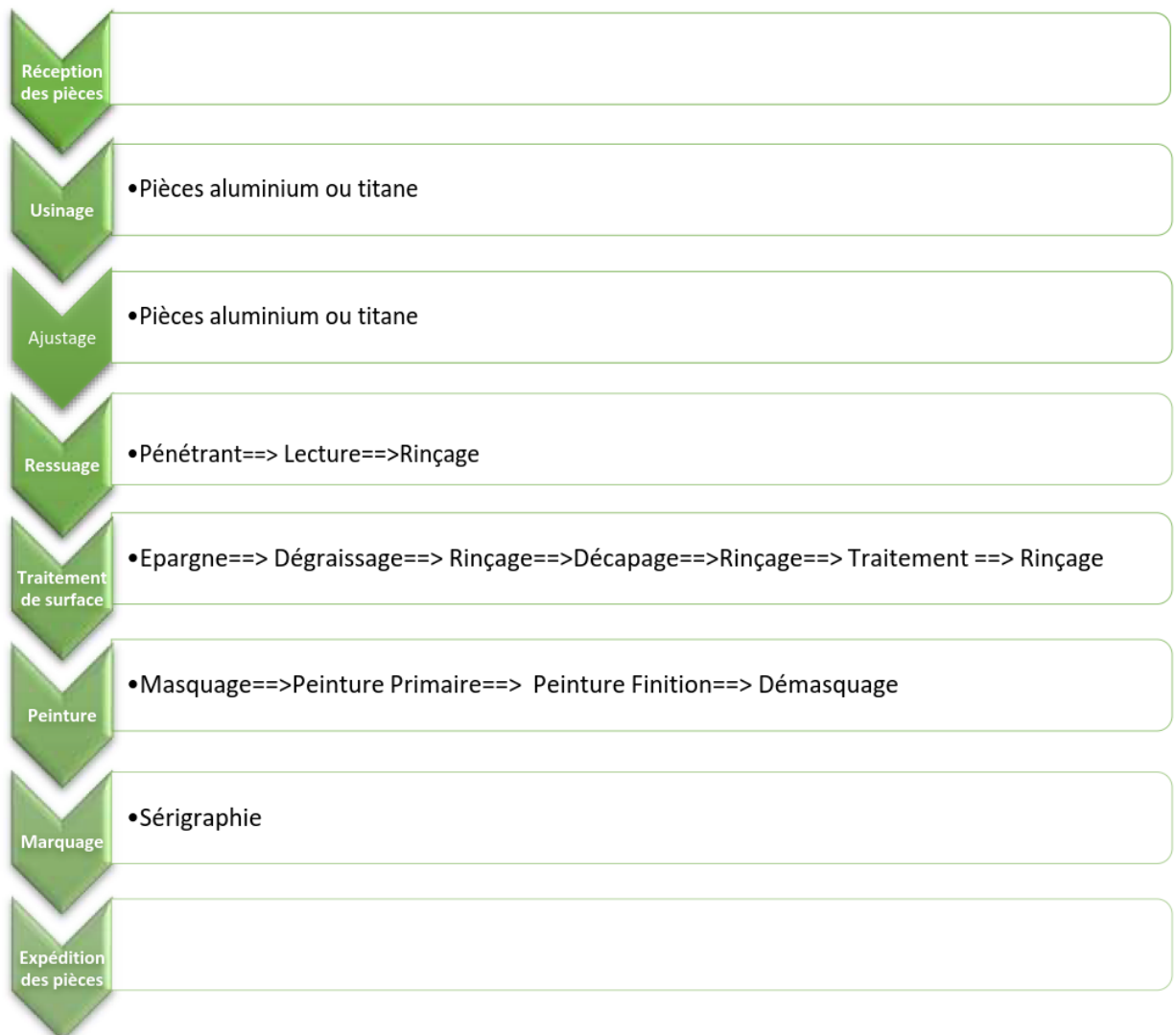
Figure 5 : Synoptique de fabrication des pièces
