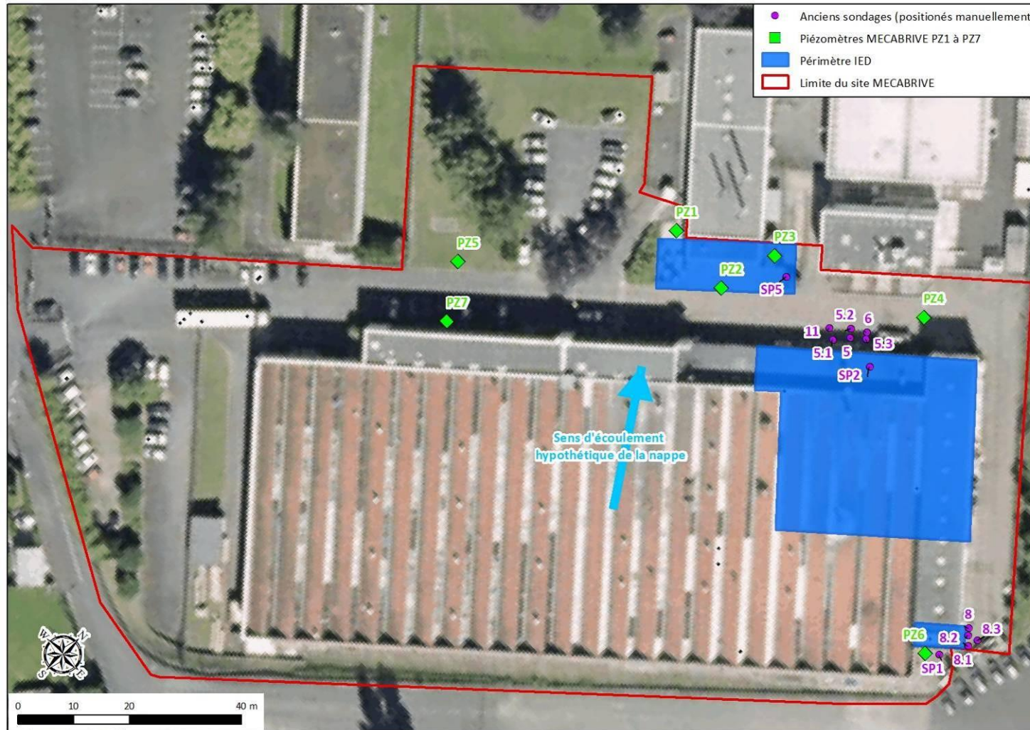
Figure 12. Localisation des sondages de sol et des piézomètres situés à proximité du périmètre IED
